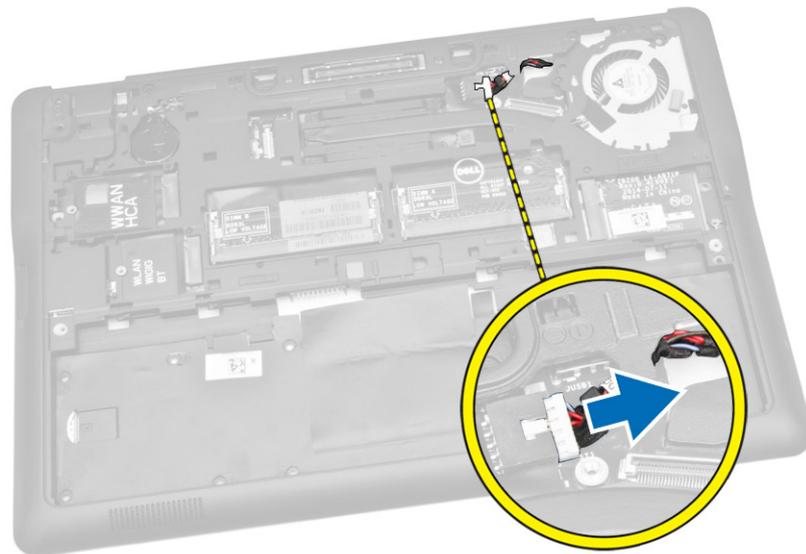
4. スピーカーケーブルと [1]、SIM ボードケーブルを [2] [3]、システム基板のコネクタから取り外します。
